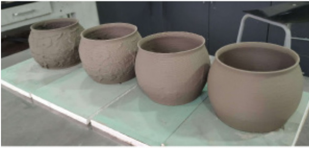
Fig. 10 Piezas impresas en estado cuero. De derecha a izquierda, valores de textura 7, 4, 2 y 0 mm
