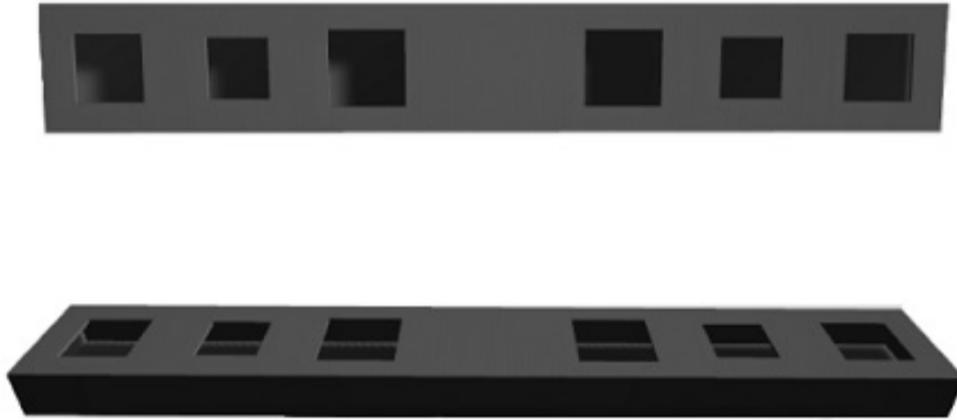
a. Placa difusora unidimensional fabricada en impresión 3D en base a calcular una frecuencia central de funcionamiento. Este material cumple la función de dispersar en múltiples direcciones el sonido que incide sobre la placa. Los resultados de trabajos experimentales con este material han sido publicados en el congreso INTERNOISE 2020 realizado en Corea de Sur.
