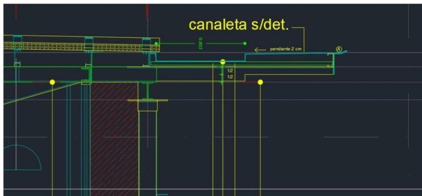
Corte simplificado del alero semicubierto de ambos lados de los edificios,
